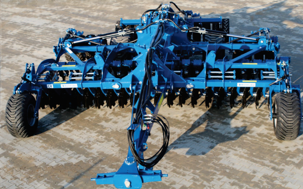
Scheibenegge U 652 mit Gummidämpfer 40 mm x 180 mm und Reifenwalze
