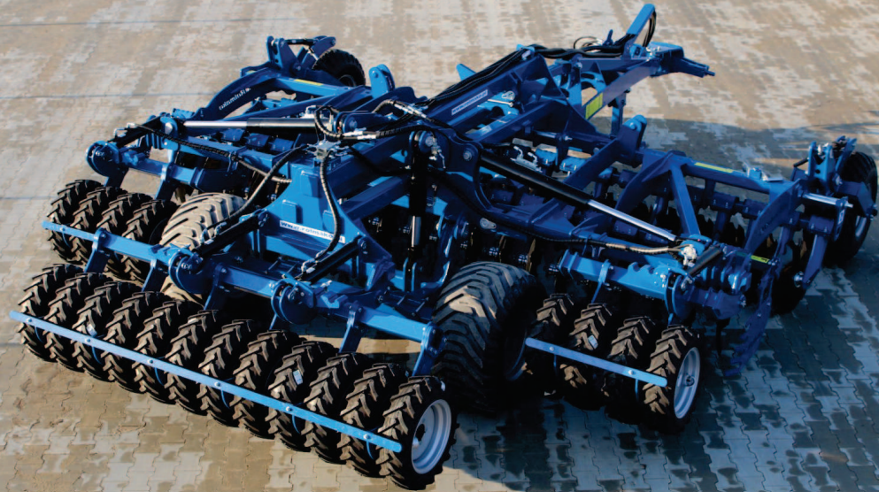
Scheibenegge U 652 mit Gummidämpfer 40 mm x 180 mm und Reifenwalze
