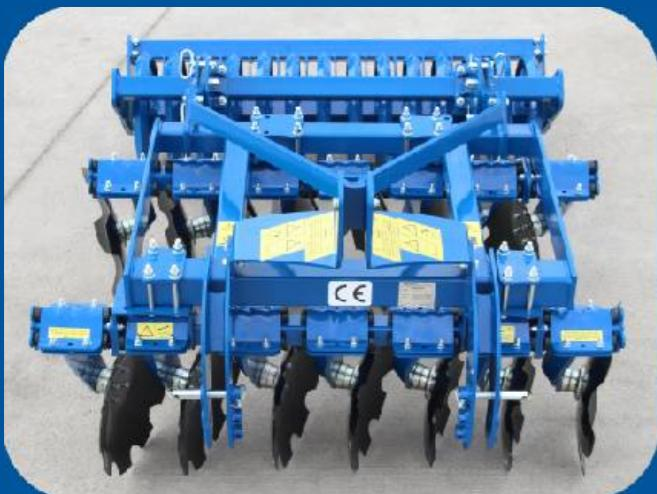
Die Basis für die Herstellung der Landmaschine bildete eine Kompaktscheibenegge, die durch die Kategorie der Anhängung sowie ihre Größe an die Arbeit mit Gartenschleppern angepasst wurde.
