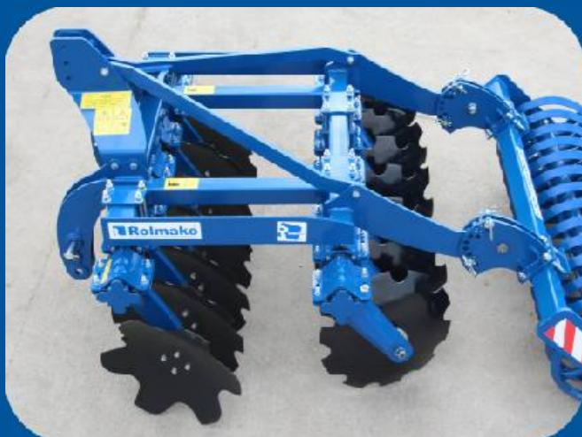
Scheibenegge U 645 ist für die Bodenlockerung und Unkrautbekämpfung zwischen den Baumreihen bestimmt. Auf spezielle Wünsche kann Rolmako auch Landmaschinen liefern, die mit ihren Parametern an konkrete Arbeiten nach Erwartungen der Obstgärtner angepasst werden.
