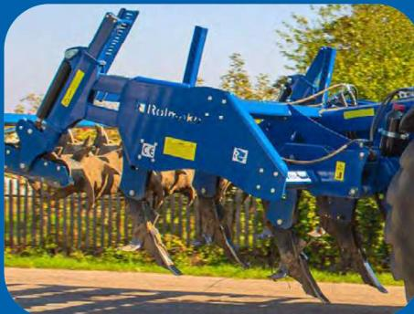
Durch die gute Gewichtsverteilung des Meißelpfluges kann die Maschine tief in den Boden eindringen, selbst bei einem sehr harten Boden. Die Maschine hat eine große lichte Fläche unter dem Rahmen, was das Verstopfen verhindert.
