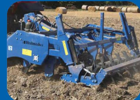
Eine besondere Anordnung der Walzenstacheln, die sich in zwei Reihen abwechseln, sorgt für einen Selbstreinigungseffekt und freien Erdfluss.
