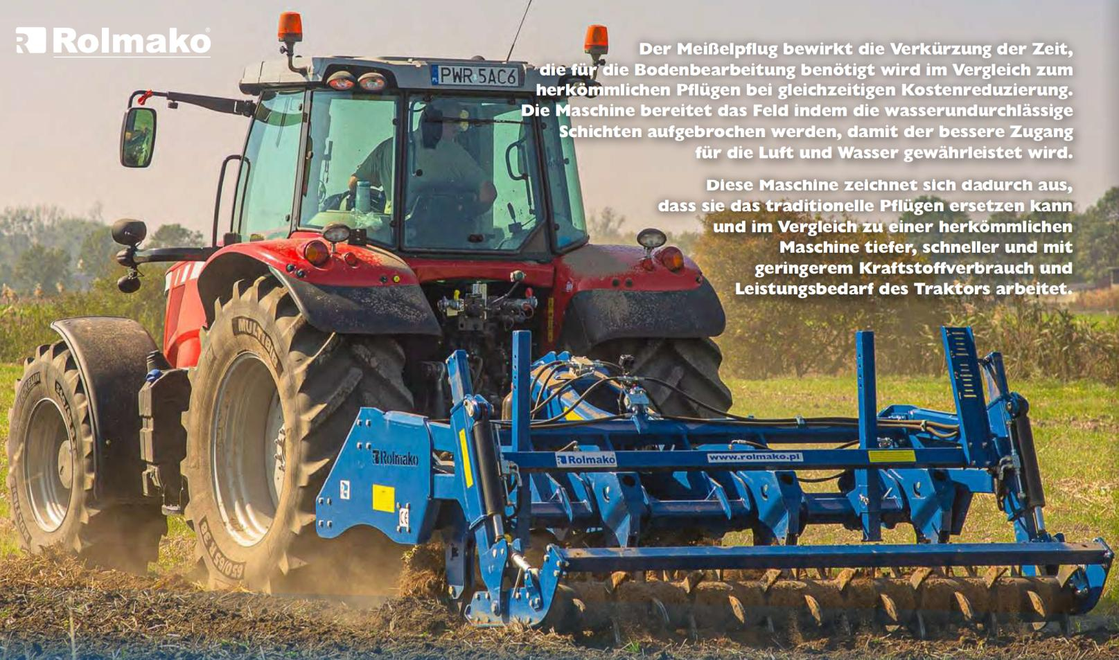
**Der Meißelpflug bewirkt die Verkürzung der Zeit, die für die Bodenbearbeitung benötigt wird im Vergleich zum herkömmlichen Pflügen bei gleichzeitigen Kostenreduzierung. Die Maschine bereitet das Feld indem die wasserundurchlässige Schichten aufgebrochen werden, damit der bessere Zugang für die Luft und Wasser gewährleistet wird.**
