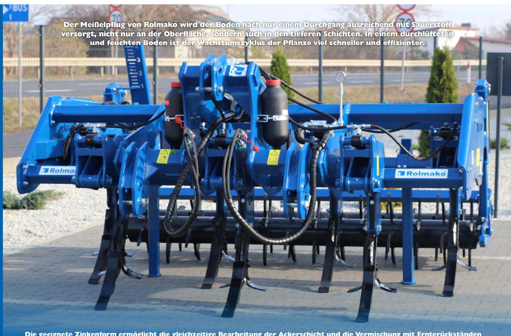
**Die geeignete Zinkenform ermöglicht die gleichzeitige Bearbeitung der Ackerschicht und die Vermischung mit Ernterückständen**
