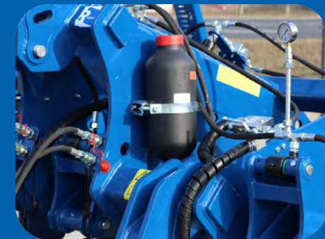
Dank eines hydropneumatischen Systems, das ein Anheben der Zinken beim Auftreten auf Hindernisse ermöglicht, ist das Gerät auf steinreichen Böden sehr effektiv. Der Meißelpflug ist mit verschiedenen Qualitätsausführungen der Arbeitsteile erhältlich. Die Standardkomponenten aus Borstahl können durch beschichtete Pflugteile oder eine Ausführung mit eingebautem gesintertem Carbidhartmetall ersetzt werden.
