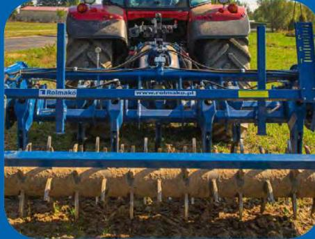
Der Meißelpflug ist mit einer Zwei-Reihen-Sektion von Zinken mit seitigen Messern und einer Doppel-Stachelwalze mit der hydraulischen Tiefenverstellung ausgestattet. Durch die Beibehaltung einer Fahrgeschwindigkeit von 10 km/h kann die Maschine große Flächen in kürzerer Zeit bearbeiten.
