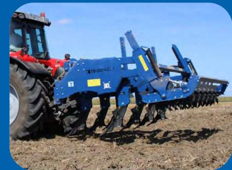
Der gesamte Bodenbearbeitungsvorgang wird durch eine doppelte Stachelwalze mit hydraulischer Verstellung abgeschlossen, die gleichzeitig die entstehenden Klumpen aufbricht, die Oberfläche des Feldes glättet und die Verdunstung durch Schließen der Pflugspuren unterbricht.
