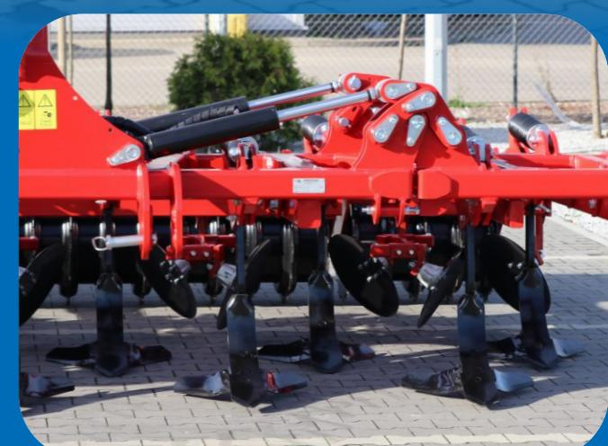
Pflügelemente, die durch eine Schraube oder eine NON-STOP-Feder gegen Überlastung geschützt sind
