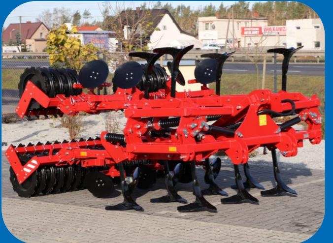
Die auf diese Weise zusammengeklappte Maschine ist bequem und sicher zu transportieren. Während des Transports ist das Gewicht der Maschine im Verhältnis zu den Aufhängungen des Ackerschleppers relativ gering.
