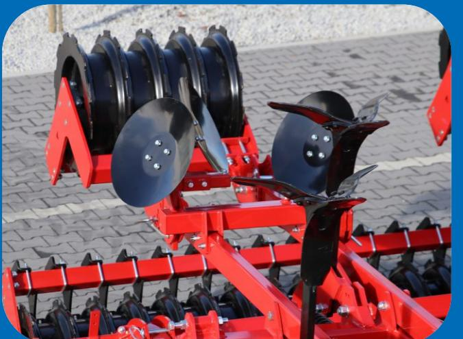
**Der Grubber ist serienmäßig mit Endscheiben ausgestattet, um präzise Arbeiten an der Feldgrenze durchzuführen und Bodenschäden an den Maschinenseiten zu vermeiden**
