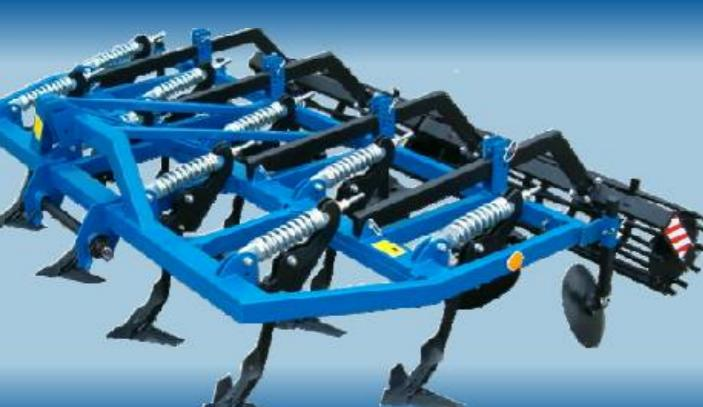
Auf dem Foto Schälgrubber in der Arbeitsbreite von 3,9m. Er besteht aus 9 Arbeitskomponenten und 10 Einebnungsscheiben.
