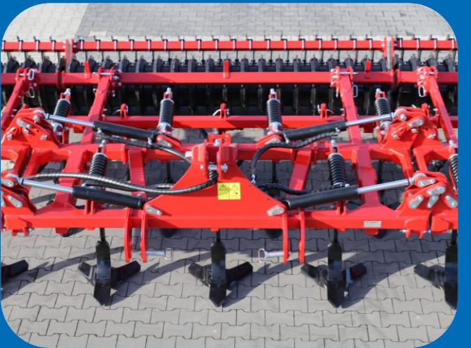
Hydraulisch klappbare Maschinen U 453 sind mit einer Schlepperkupplung nach Kategorie III ausgerüstet.
