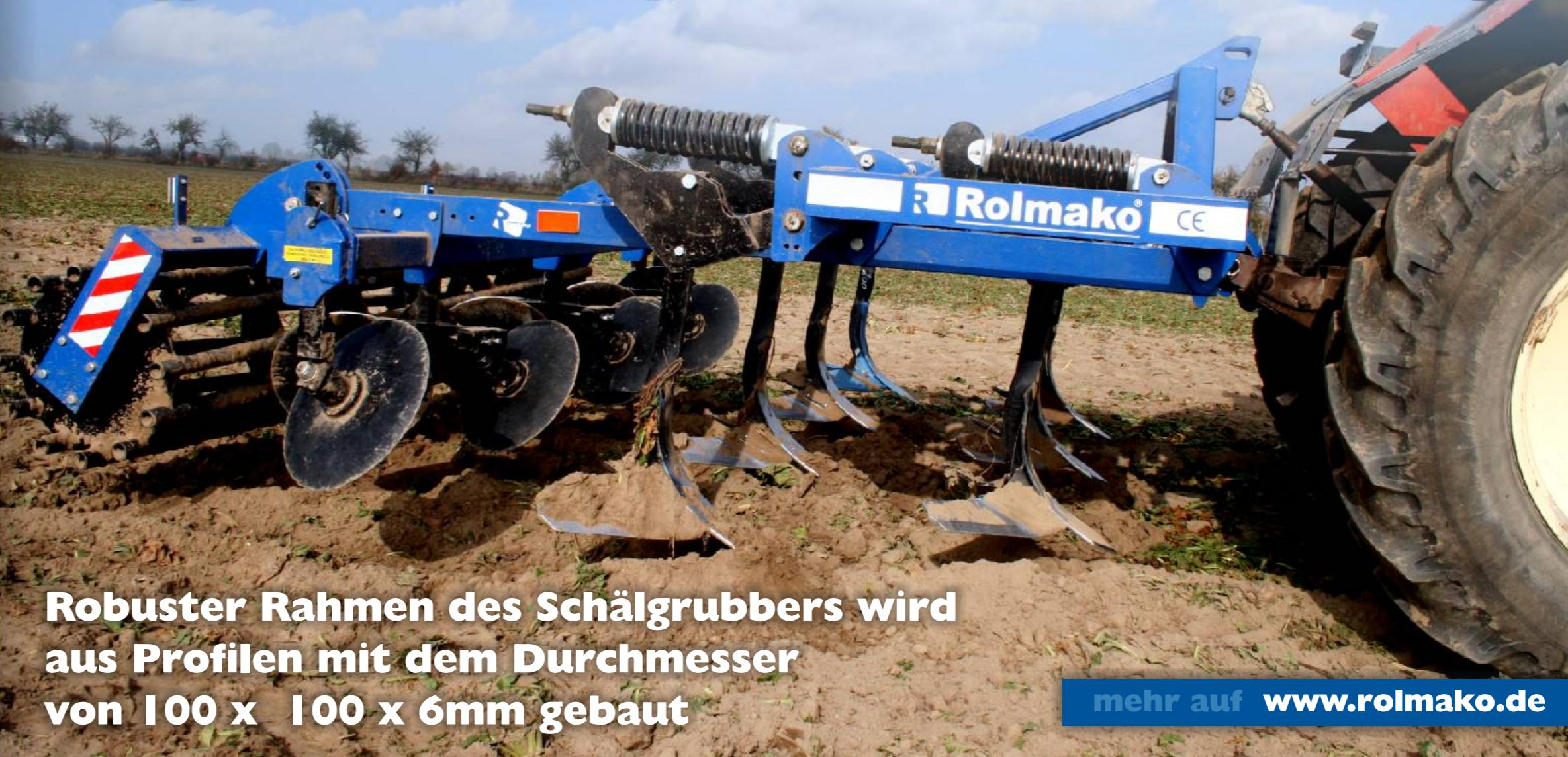
**Robuster Rahmen des Schälgrubbers wird aus Profilen mit dem Durchmesser von 100 x 100 x 6mm gebaut**
