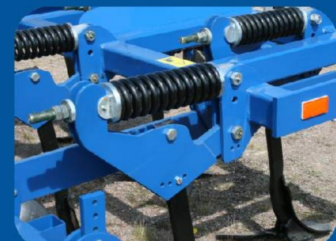
Eine erfolgreiche Bodenbearbeitung Dank der Kombination von Zinken mit Wurzelschneidern, Einebnungsscheiben und der Regulierung der Arbeitstiefe sowie einer entsprechender Walze
