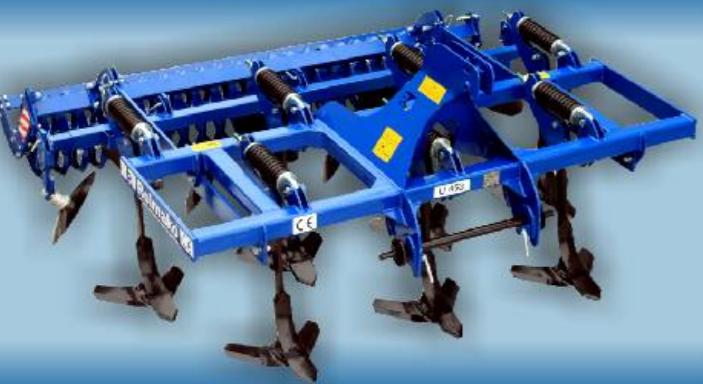
Schälgrubber GRUBBER PLUS bedeutet eine höhere Bodenfreiheit unter dem Rahmen, ein neues attraktives Aussehen sowie ein größerer Scheibendurchmesser. Die Maschine ist in Arbeitsbreiten von 3m und 3,9m erhältlich.
